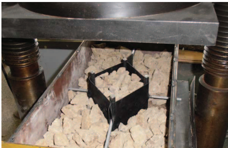
Рис. 3. Армирование щебеночной среды геосотовым материалом
