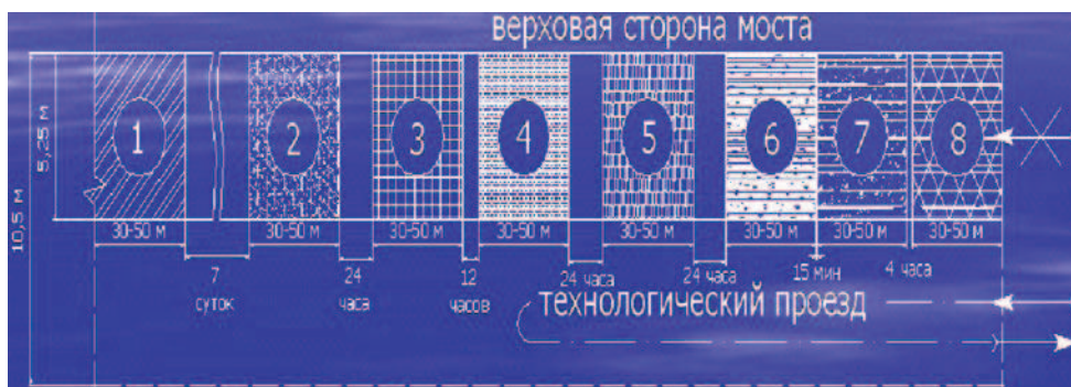
Рис. 3. Технологическая карта по устройству мостового полотна на железобетонных плитах проезжей части (гидроизоляция «Мастика»): 1 – устройство выравнивающего бетонного слоя по железобетонным плитам – 30÷70 мм; 2 – промазка по высушенной поверхности бетонных элементов, к которым примыкает дорожная одежда разжиженным полимербитумом; 3 – расстилка сетки из полиэстера – 4 мм; 4 – укладка гидроизоляционного слоя из полимербитумной мастики – 20 мм; 5 – устройство нижнего слоя асфальтобетонного покрытия типа А – 40 мм; 6 – устройство верхнего слоя асфальтобетонного покрытия – литой асфальтобетон тип I, II – 40 мм; 7 – россыпь и прикатка оcherненного щебня; 8 – проливка мест сопряжения дорожной одежды с элементами мостового полотна полимербитумом ПБВ 60
