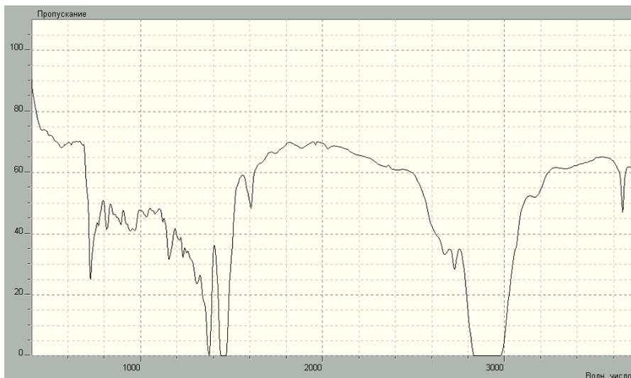
Рис. 4. ИК-спектр образца № 4
