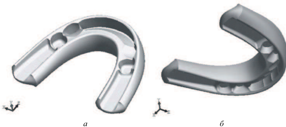
Рис. 7. Иллюстрация компьютерной модели эластопозиционера: а – вид сверху, б – вид снизу
