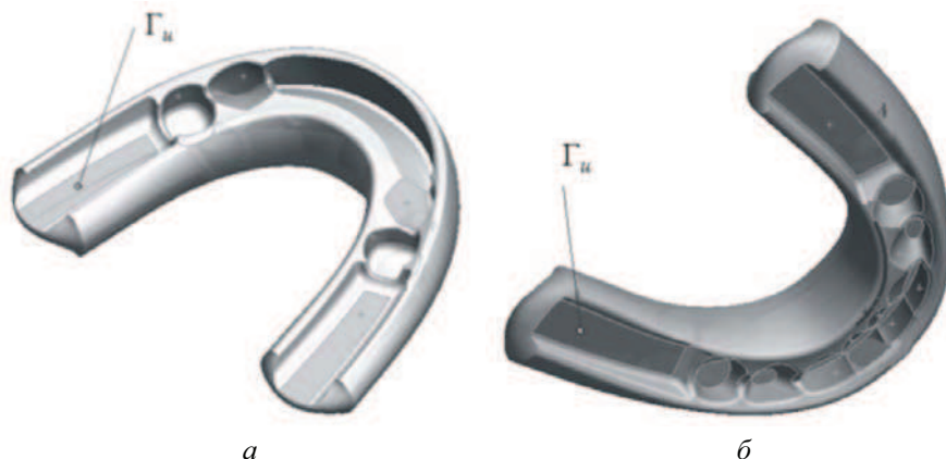
Рис. 8. Неподвижные области эластопозиционера \Gamma_u помечены темно-серым цветом: a – вид сверху, б – вид снизу
