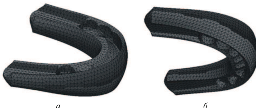
Рис. 10. Разбиение эластопозиционера на конечные элементы: a – вид сверху, б – вид снизу
