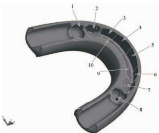
Рис. 12. Максимальные величины компонент напряжений на контакте с зубами
