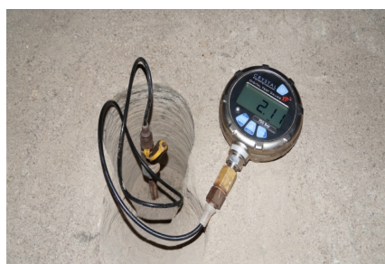
Рис. 3. Измерение давления свободных газов в замерной станции с помощью цифрового манометра Crystal XP2i
