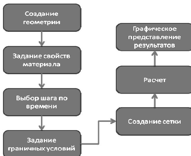
Рис. 4. Схема работы пакета ABAQUS
