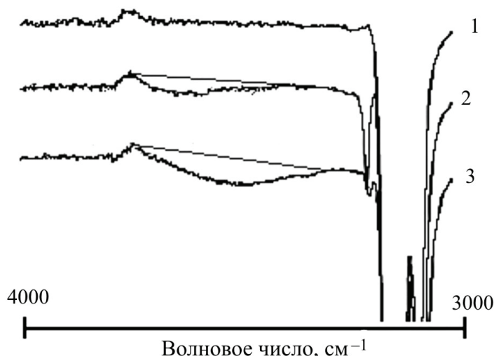
Рис. 2. Область спектра в диапазоне волновых чисел 3000\text{--}4000\text{ см}^{-1} для образцов гексана (1), масляная фаза исследуемого образца (2), спиртовая фаза исследуемого образца (3)
