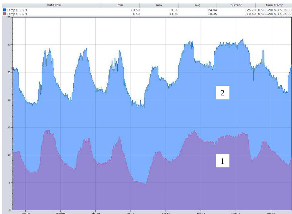
Рис. 3. Температура воды на входе 1 и выходе 2 системы охлаждения группы компрессоров
