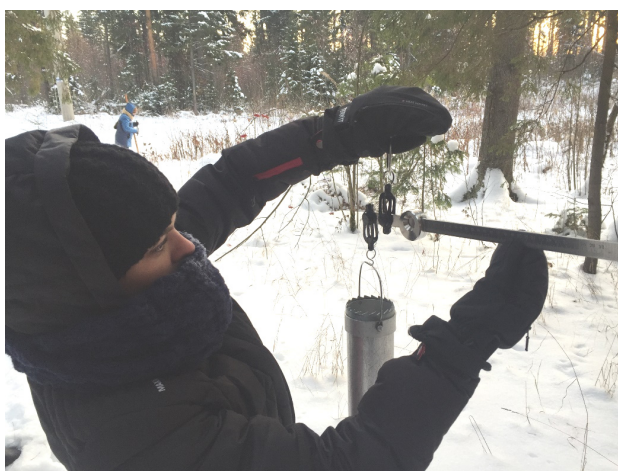
Рис. 5. Определения плотности снега и запаса воды в снежном покрове с помощью весового снегомера ВС-43
