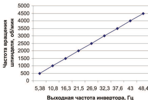
Рис. 2. Зависимость частоты вращения шпинделя от выходной частоты инвертора
