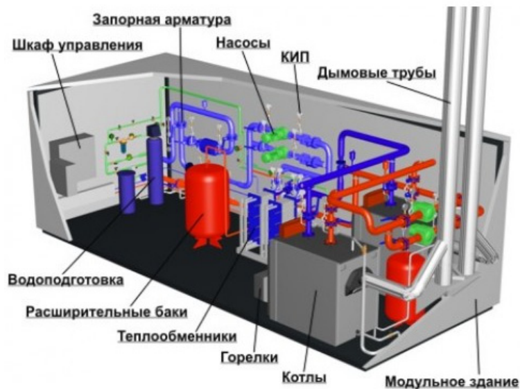
Рис. Оборудование крышной котельной
