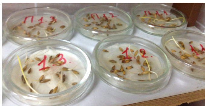
Рис. 3. Фитотест: чашки Петри с проростками овса с внесенными вытяжками одной из проб ОСС в трех разведениях
