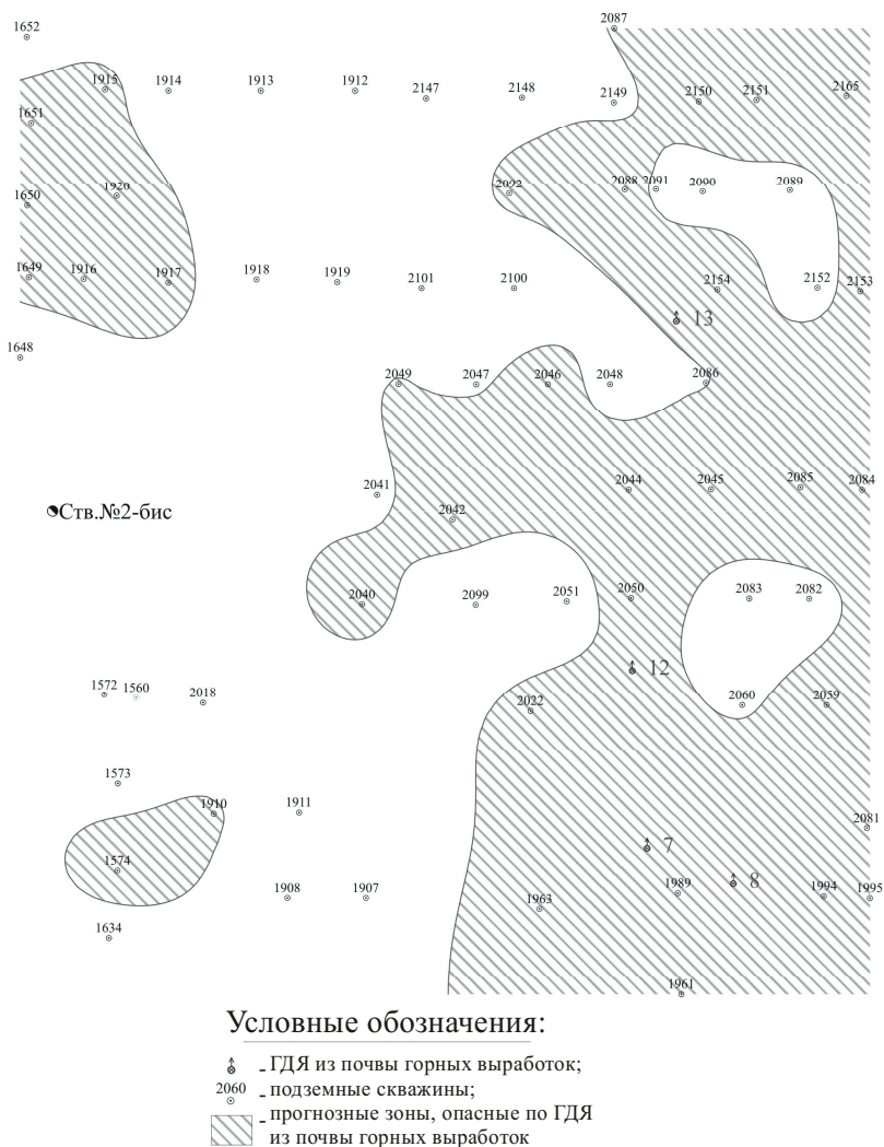
Рис. Прогнозная карта зон, опасных по ГДЯ из почвы горных выработок, при комбайновой отработке карналлитового пласта В для условий рудника СКПРУ-1 ОАО «Сильвинит»
