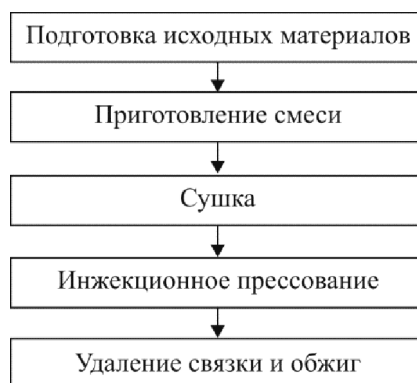
Рис. 2. Технологический процесс изготовления изделия методом инъекционного формования
