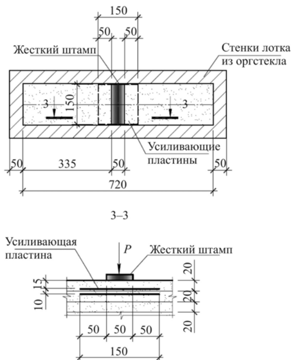
Рис. 3. Схема эксперимента испытания с двумя искусственными плоскостными равновеликими элементами (пластинами)
