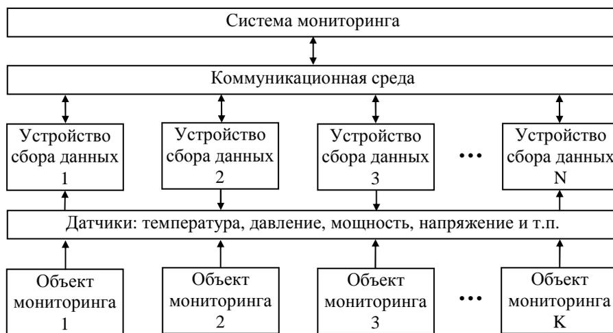
Рис. 1. Типовая схема системы мониторинга
