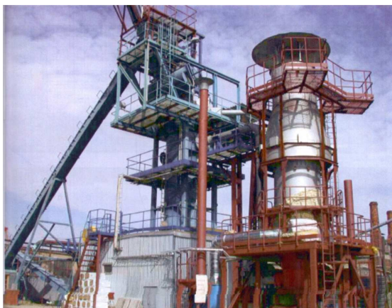
Рис. 2. Газификатор в комплекте со сжигающим устройством на экспериментальной площадке ФГУП ММП «Салют»
