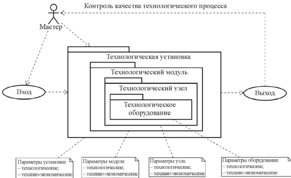
Рис. 4. Описание технологической установки на языке UML
