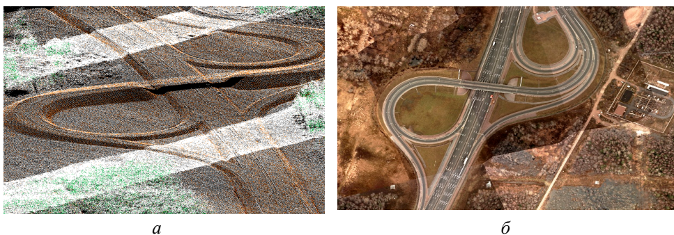
Рис. 4. Результаты воздушного лазерного сканирования трассы Москва – Санкт-Петербург: а – облако точек; б – ортофотоплан
