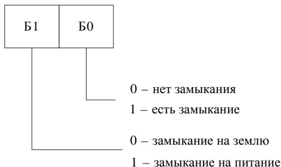
Рис. 4. Регистр состояния каждого вывода
