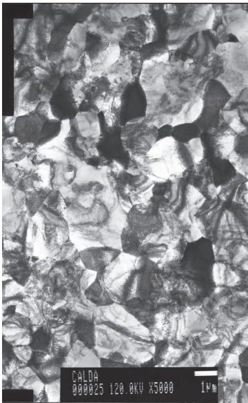
Рис. 1. Тонкая структура листа из сплава Ti-6Al-4V толщиной 1 мм в просвечивающем электронном микроскопе
