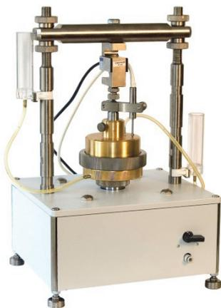
Рис. 3. Прибор для компрессионного сжатия
