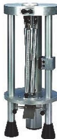
Рис. 2. Устройство для раскатывания связного грунта в жгут ГТ 1.8.2
