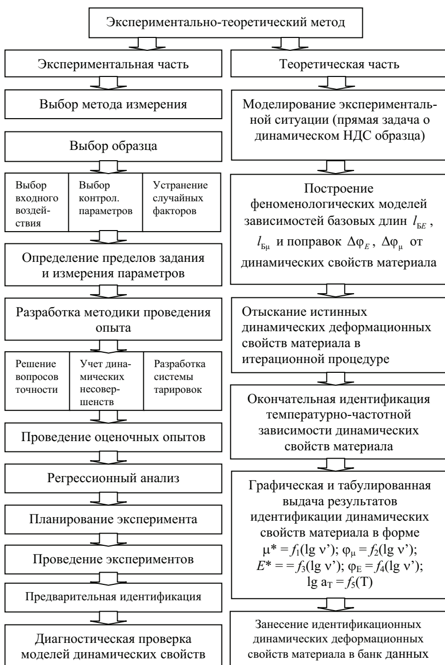
Рис. 1. Структура экспериментально-теоретического метода идентификации динамических свойств вязкоупругих материалов
