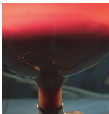
Рис. 1. Разделение образца масла № 1 после отстаивания в делительной воронке в течение 7 сут
