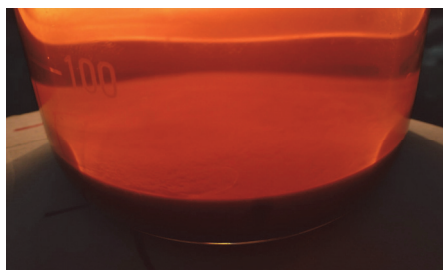
Рис. 3. Внешний вид модельной смеси масла и воды (концентрация воды 0,05 мас.%) после термостатирования в течение 24 ч при температуре 80 °С
