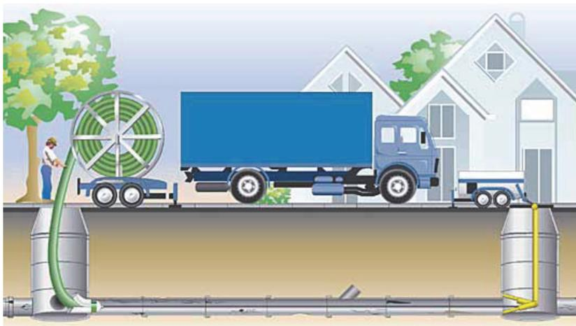
Рис. 4. Непрерывная облицовка, плотно прилегающая к стенкам трубопровода, с использованием полиэтиленовых труб
