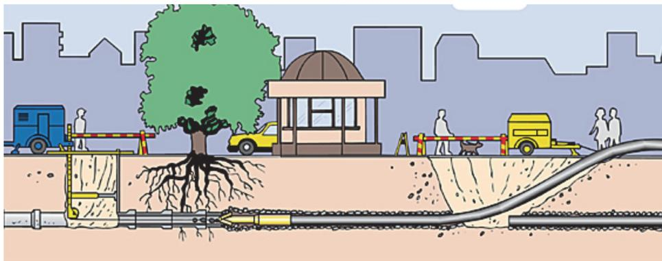
Рис. 2. Метод ремонта трубопроводов с разрушением старой трубы
