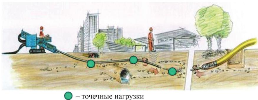
Рис. 9. Метод горизонтально направленного бурения
