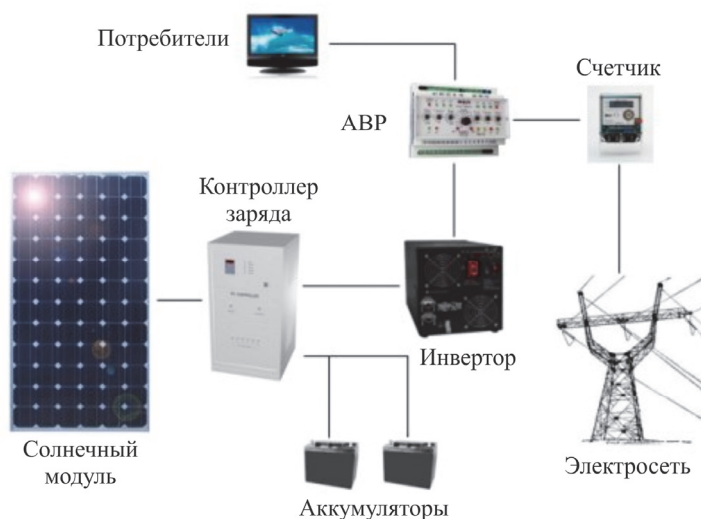
Рис. 5. Схема электроснабжения научно-исследовательского модуля
