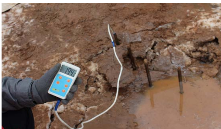
Рис. 3. Измерение температуры с помощью металлических трубок
