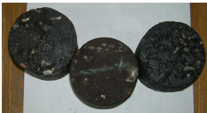
Рис. 2. Образцы асфальтобетона (цветной асфальтобетон в центре)
