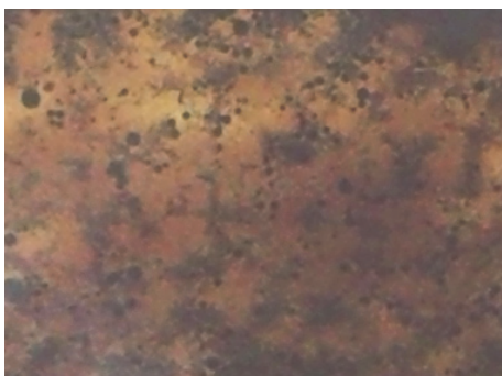
Рис. 2. Диспергирование нефти, разрушение поверхностной нефтяной пленки
