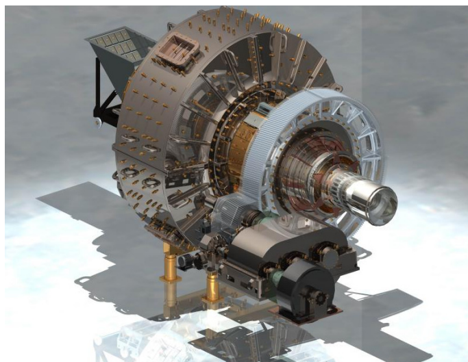
Рис. 1. Мельница мокрого самоизмельчения «Гидрофол» ММС 7,0×2,3
