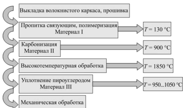
Рис. 2. Последовательность изготовления углерод-углеродного материала
