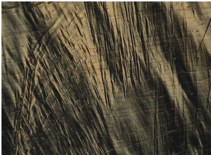
Рис. 2. Зоны макроскопической локализации пластической деформации в монокристалле Fe-3 % Si на стадии линейного упрочнения, обнаруженные методом оптической микроскопии ( a ) и методом спекл-интерферометрии ( б ), на примере распределений локальных удлинений \epsilon_{xx}
