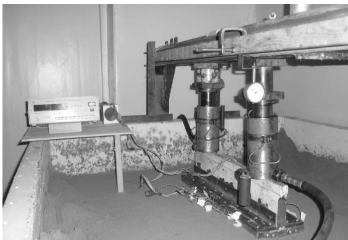
Рис. 1. Модель фундамента под нагрузкой
