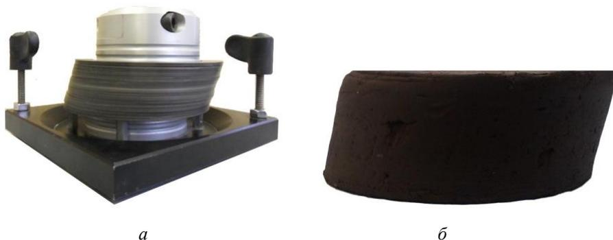
Рис. 2. Деформации простого сдвига (скашивания):
