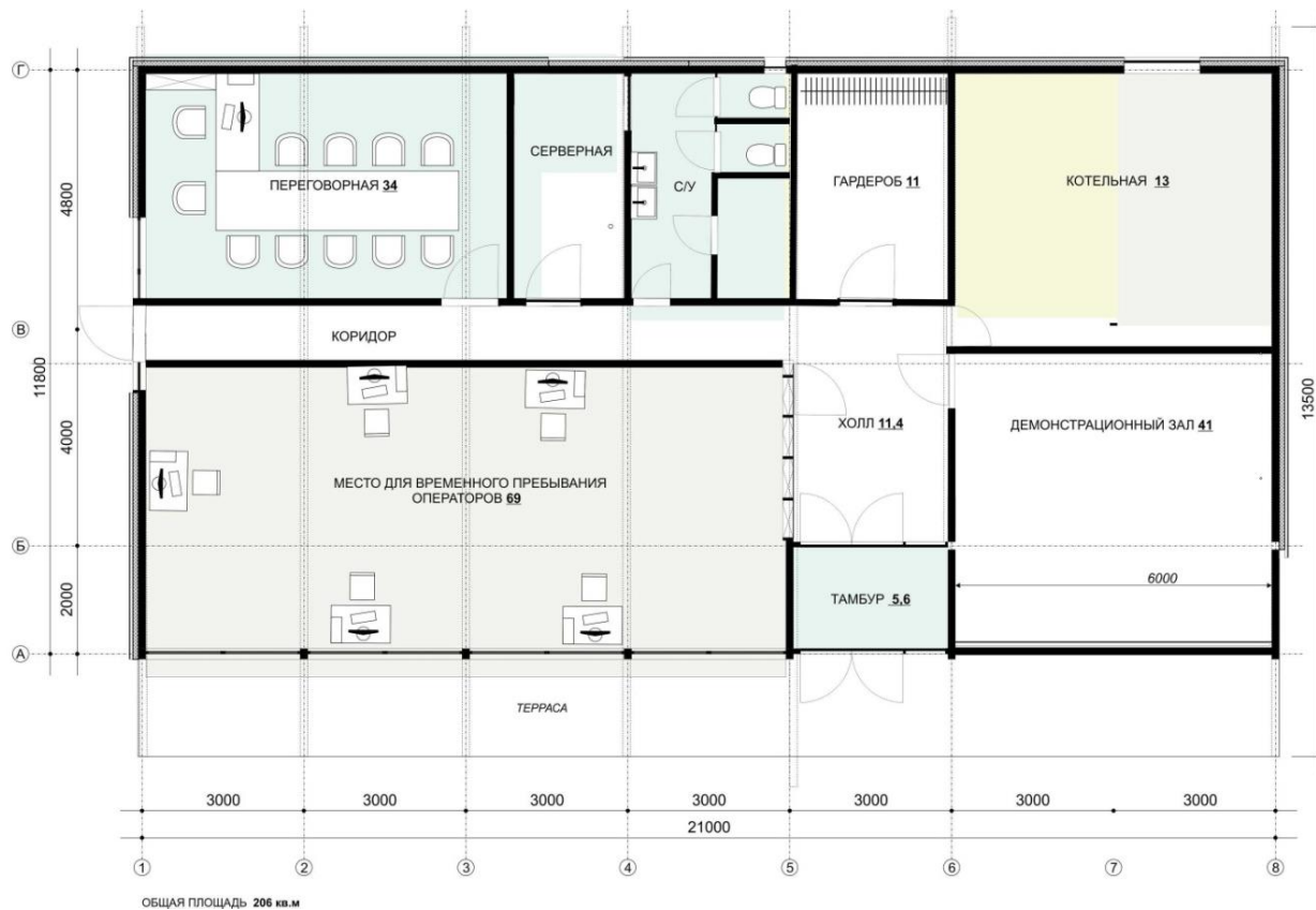
Рис. 2. Функциональные помещения модуля (лабораторной установки)
