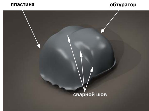
Рис. 2. Общий вид рассчитываемой модели. Поскольку различия в толщине малы на фоне общих размеров, здесь не изображаются отдельно виды разнотолщинной и однотолщинной конструкций
