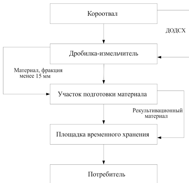
Рис. 3. Общая технологическая схема переработки ДОДСХ
