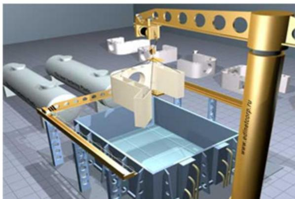
Рис. 2. Готовая опалубка
