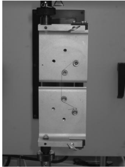
Рис. 2. Захваты для испытания нитей
