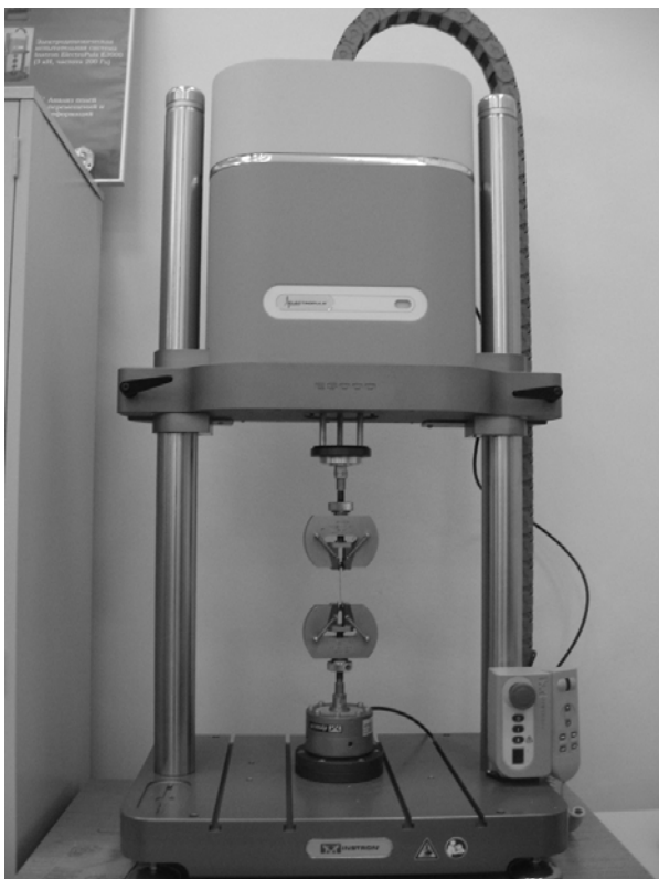
Рис. 2. Захваты для испытания нитей
