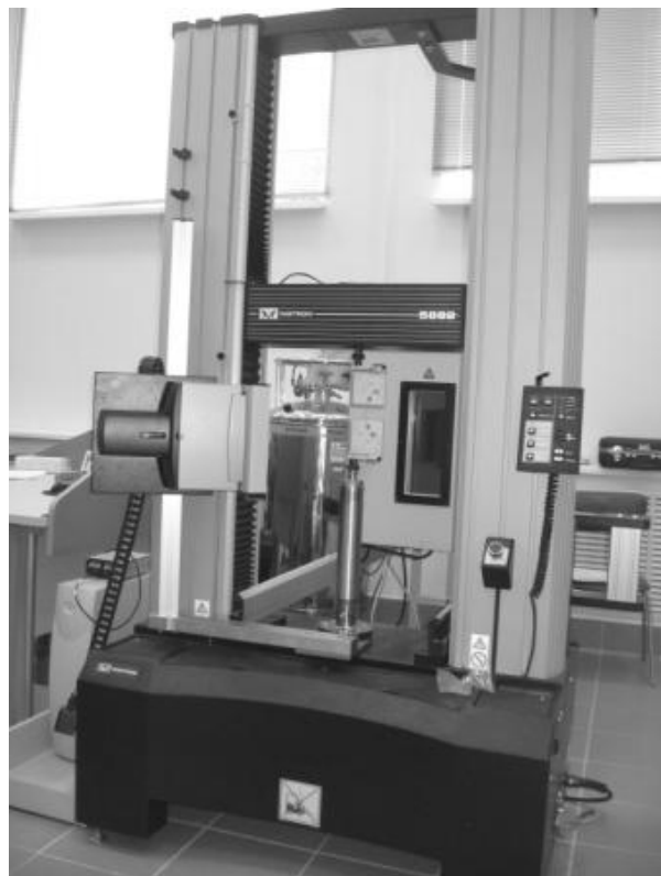
Рис. 2. Захваты для испытания нитей
