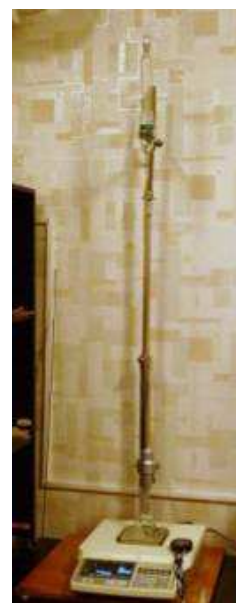
Рис. 4. Напорная колонка с образцом
