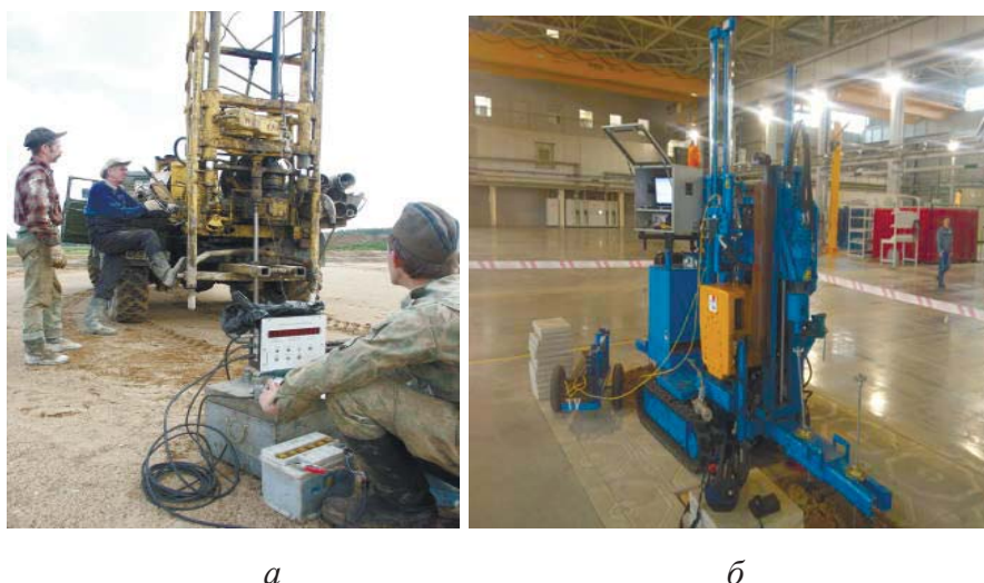
Рис. 1. Зондирующие установки: а – на базе КамАЗа; б – малогабаритная установка LWC-100XC
