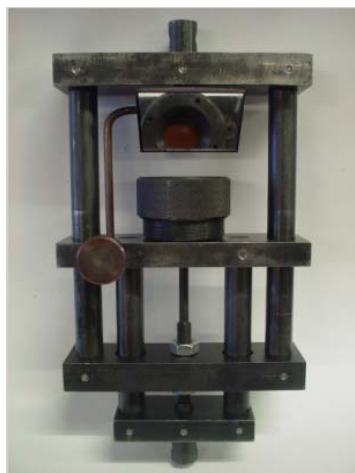
Рис. 2. Прибор МТ 374 для определения разрывных характеристик полотна при продавливании шариком
