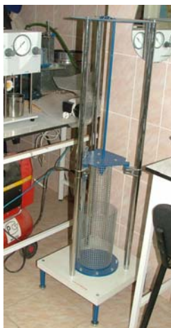
Рис. 1. Прибор МТ 375 для определения сопротивления падающему конусу
