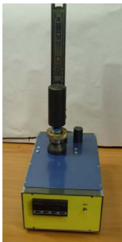
Рис. 3. Прибор МТ 372 для определения устойчивости покрытия к мокрому трению
