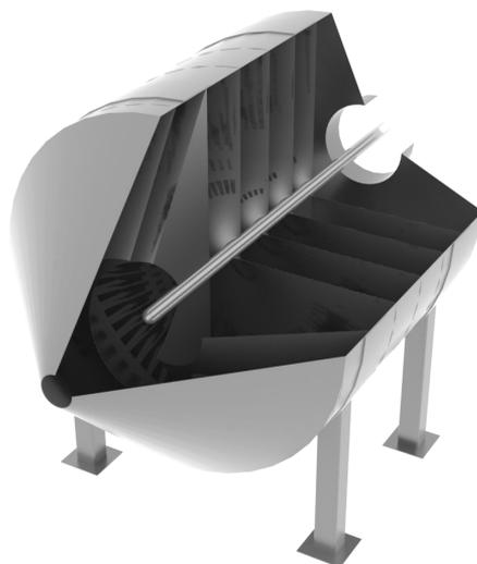
Рис. 2. Внешний вид устройства отбора конденсированной фазы
