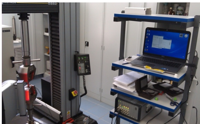
Рис. 1. Испытательная система Instron 5882 с видеоэкстензометром AVE Instron и установкой регистрации сигнала акустической эмиссии Vallen AMSY-6 в процессе испытания образца на растяжение
