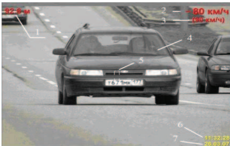
Рис. 10. Устройство ЛИСД-2Ф: 1 – дальность до транспортного средства в метрах; 2 – измеренная скорость транспортного средства в км/ч (если транспортное средство движется на оператора, то значение скорости отображается со знаком «минус»); 3 – допустимая скорость в км/ч (в круглых скобках); 4 – изображение транспортного средства; 5 – область лазерного излучения; 6 – время измерения; 7 – дата измерения
