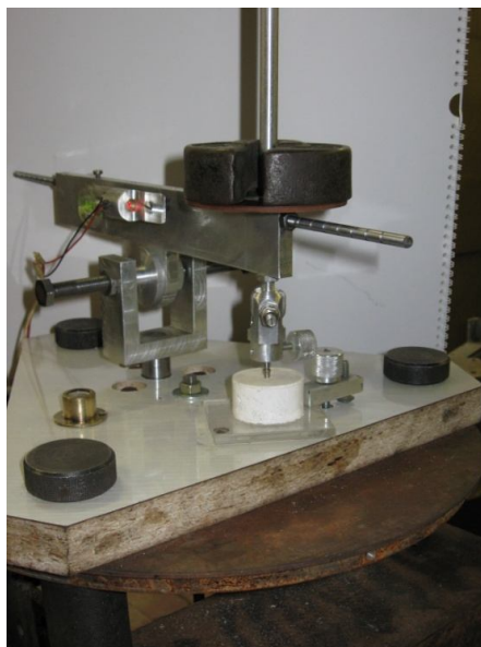
Рис. 1. Фотография установки по определению коэффициентов жесткости для поступательных степеней свободы
