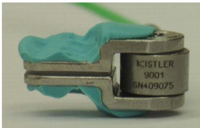
Рис. 4. Одномерный пьезоэлектрический преобразователь силы между двумя металлическими полосами, приспособленными к индивидуальной окклюзии пациента посредством установленных холодной склейкой акриловых полосок
