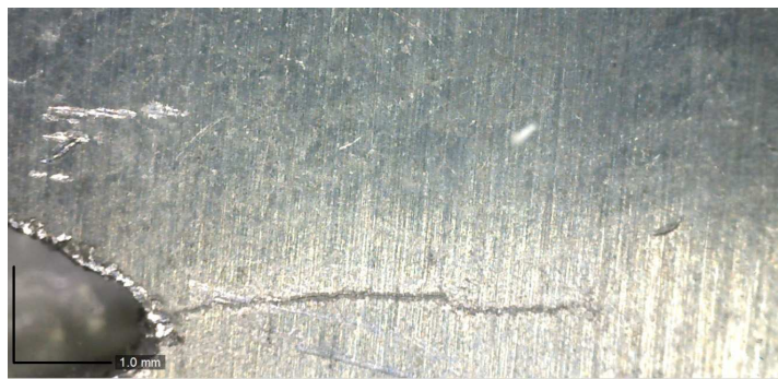
Рис. 4. Исходная усталостная трещина образцов с длиной рабочей части 100 мм
