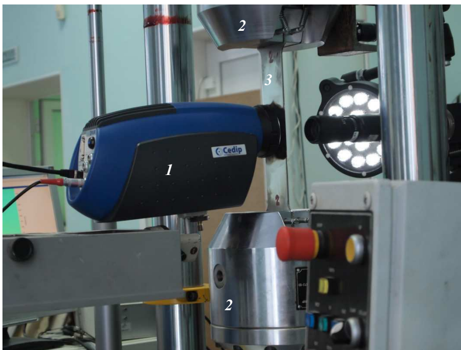
Рис. 2. Внешний вид экспериментальной установки: 1 – инфракрасная камера FLIR SC 5000; 2 – захваты сервогидравлической нагружающей машины Vi-00-100; 3 – исследуемый образец
