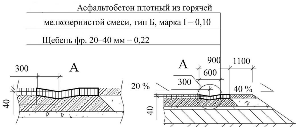
Рис. 1. Пример конструкции лотка из асфальтобетона
